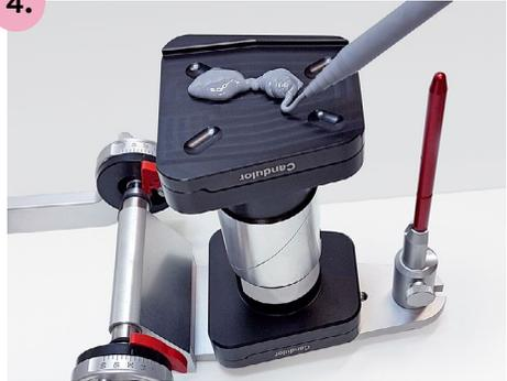
Den Zentrierschlüssel zusammen mit der Justiersockelplatte in den Artikulator setzen und Metallkleber mittig auf der Justiersockelplatte auftragen. **Wichtig: Einstellen des Vertikalstiftes auf die Position 0!**
