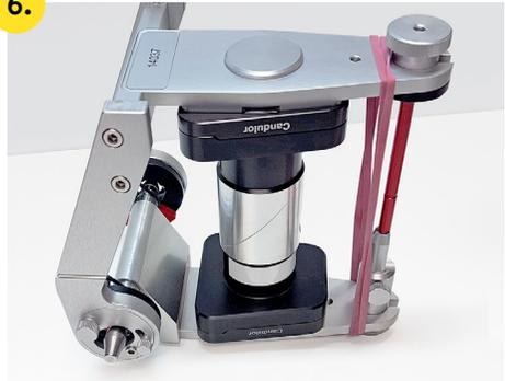
Den Artikulator mit einem Gummiband fixieren und den Kleber für ca. 90 Min. aushärten lassen.
