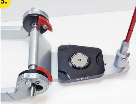
Die Sockelplatte in das Artikulatoroberteil einsetzen. Das Magnet fixiert die Sockelplatte und der Kleber sorgt für den dauerhaften Halt. Den Kleber mindestens 90 Min. aushärten lassen. Erst im Anschluss die untere Platte verkleben.
