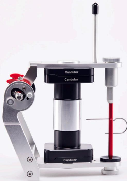
Grâce à l'accessoire d'étalonnage, CA 3.0 LARGE est ajusté en hauteur à 126 mm et peut être calibré avec les articulateurs Artex®\*.
